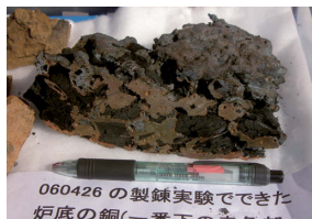
炉底に残った金属塊。温度が高すぎて大量の金属鉄(白色)が生じている。赤色の部分が銅で黒色は木炭。
