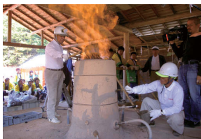
復元した堅型炉による銅製錬実験の様子
