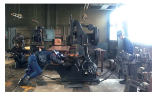
今年、伊都キャンパスから戻ってきた「立削り盤(スロッター)」
