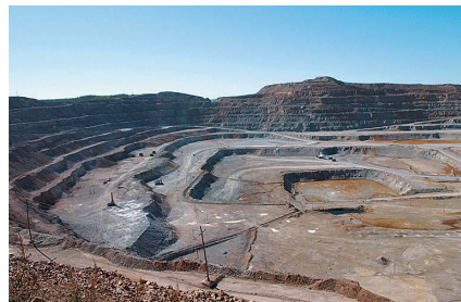
Erdenet 鉱山の露天採掘(ベンチ1段は15m)
